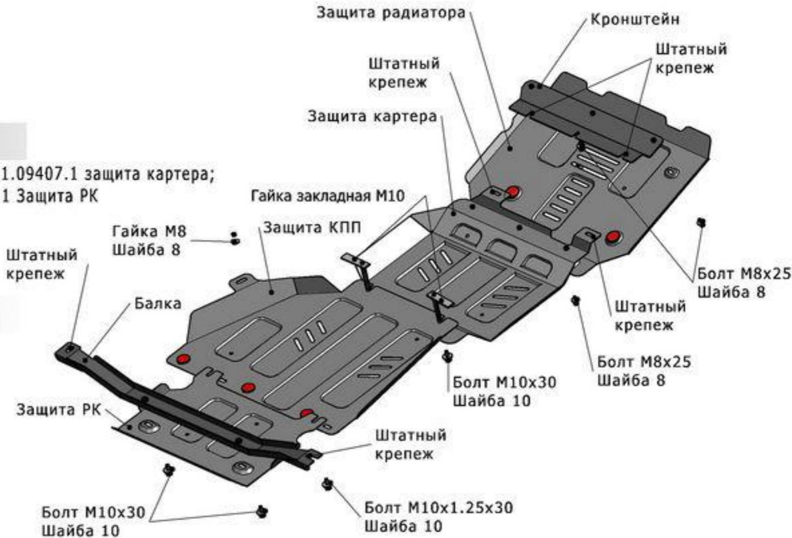
7. Установить защиту картера: заднюю часть защиты завести на установленные болты M10x30, переднюю часть закрепить штатным крепежем(Пункт 6).
